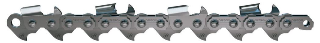
大负荷锯链：用于切割大型木材，适合那些操作大型链锯的专业用户使用；全直角刀头提供专业切割性能；限位齿的特殊设计降低反弹。
