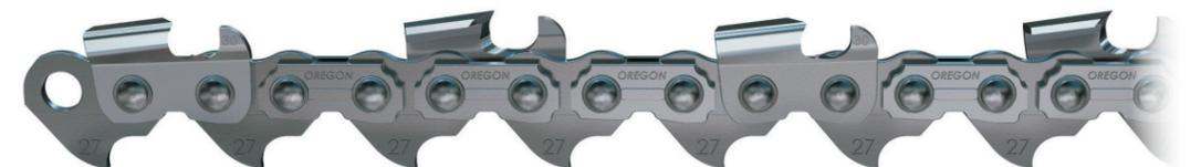
27R、27RX系列是专业剖木锯链。该系列的刀头基于剖木用途进行了特殊设计，便于将大型木材和原木切割成不同尺寸的木板。另外，27RX刀头和刀头之间的间距较大。在切割过程中，刀头的这种排列方式使大木屑更易于从切缝中排出。该锯链用于剖木加工厂作业，不建议手持使用。
